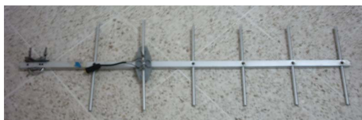
Figura 3.6 Foto de antena transmisora
