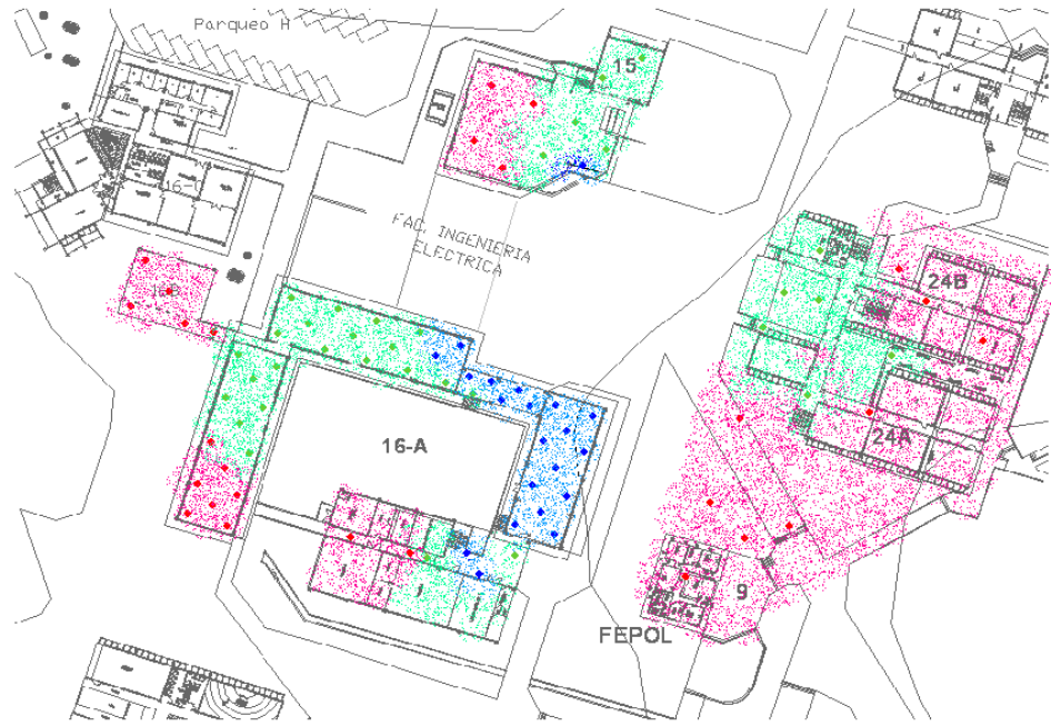
Figura 3.13 Cobertura entre 85 y 90 metros sobre nivel del mar en la FIEC
