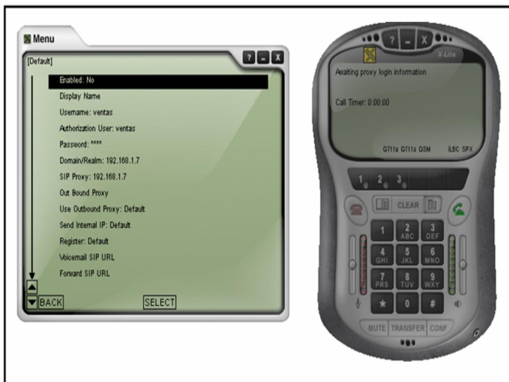
**Figura 4.38** Configuración básica del teléfono virtual X-Lite
