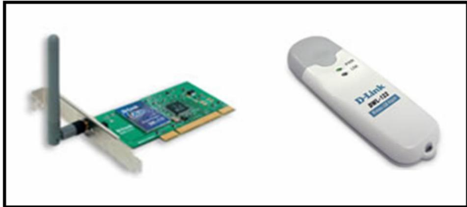
**Figura 1.1** Tarjeta de red y USB inalámbrico
