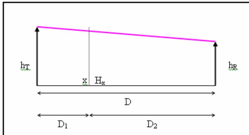
**Figura 3.5** Ilustración representativa de línea de vista
