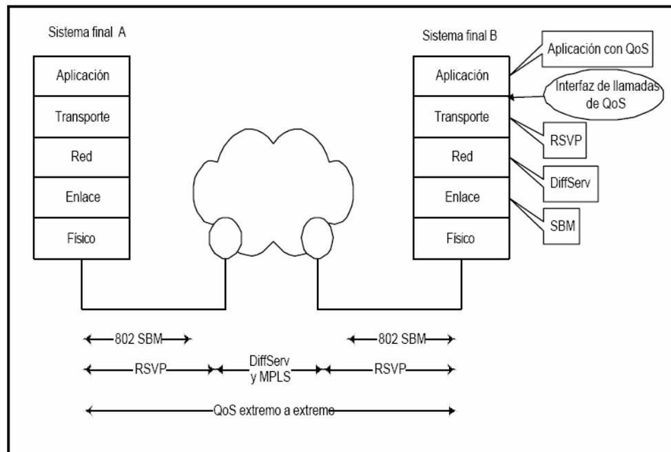
**Figura 1.29** Esquema de interacción entre tecnologías para QoS
