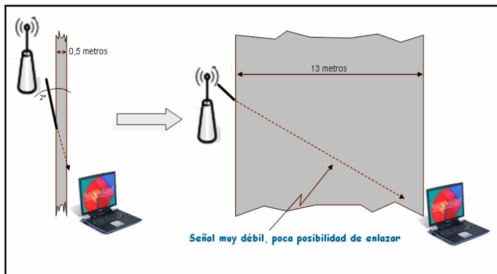
**Figura 3.8** Ilustración de obstrucción paredes en interiores
