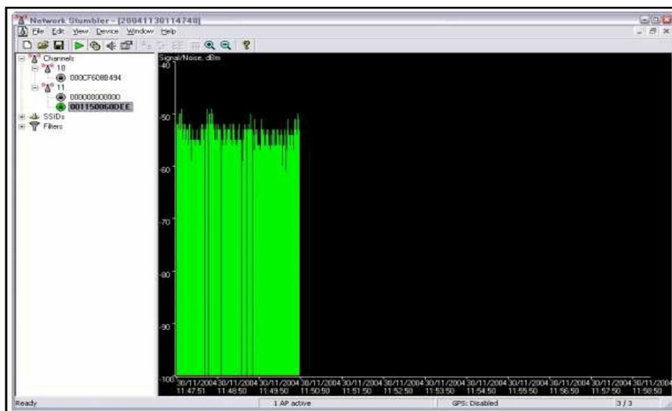
**Figura 3.15** Captura de potencia irradiada por AP
