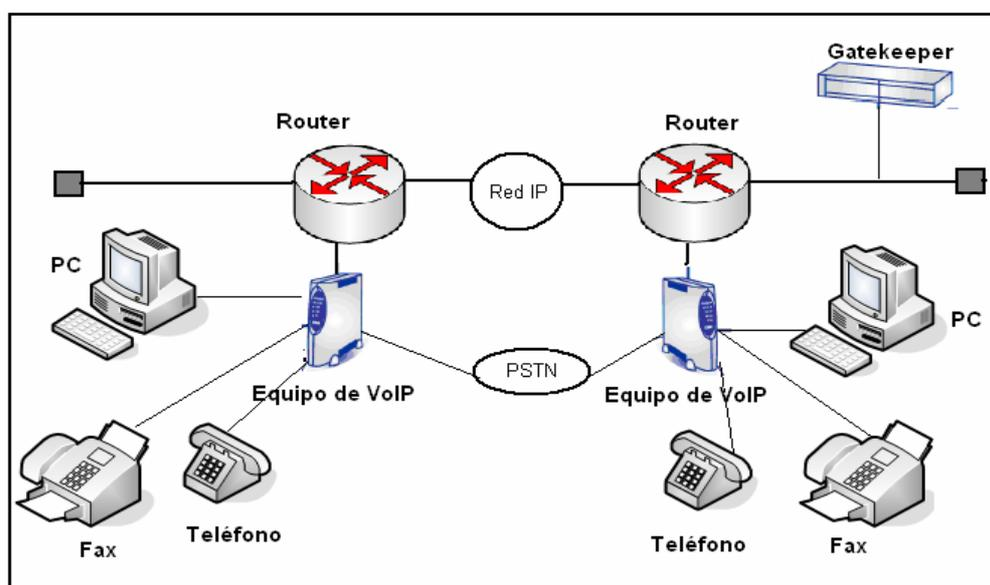
**Figura 1.25** Esquema de la conexión entre la red IP y el teléfono
