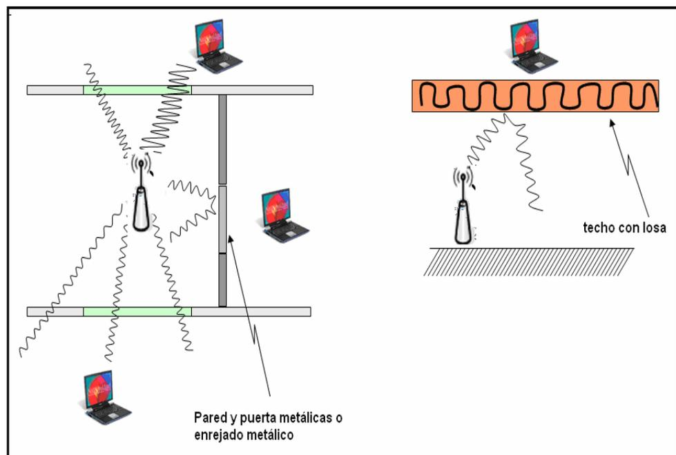
**Figura 3.7** Ilustración de obstrucción por partición de pisos
