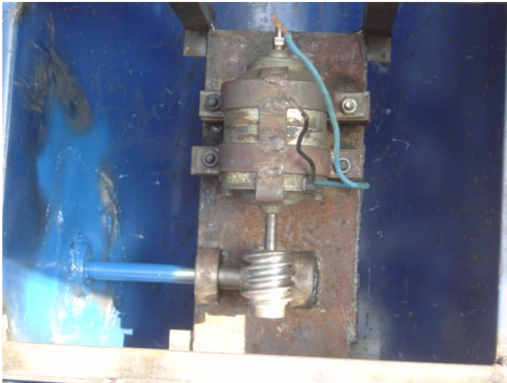
Foto E3: Motor DC adaptado al eje cruzado
