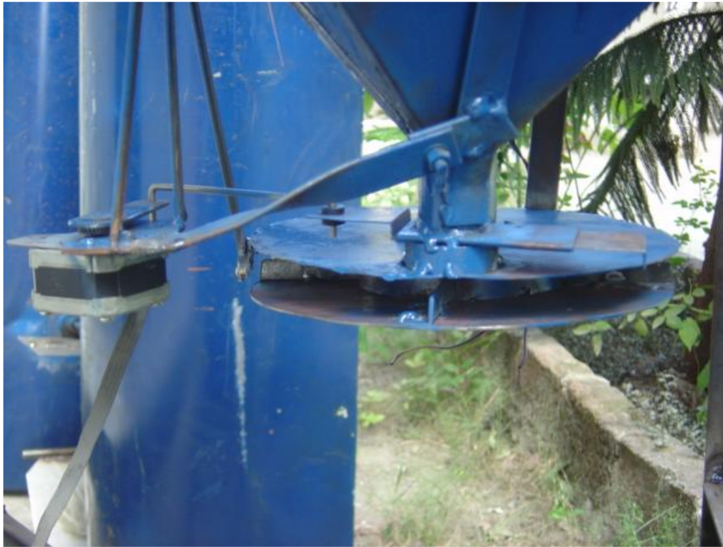
Foto E8: Sistema de control de flujo de alimento
