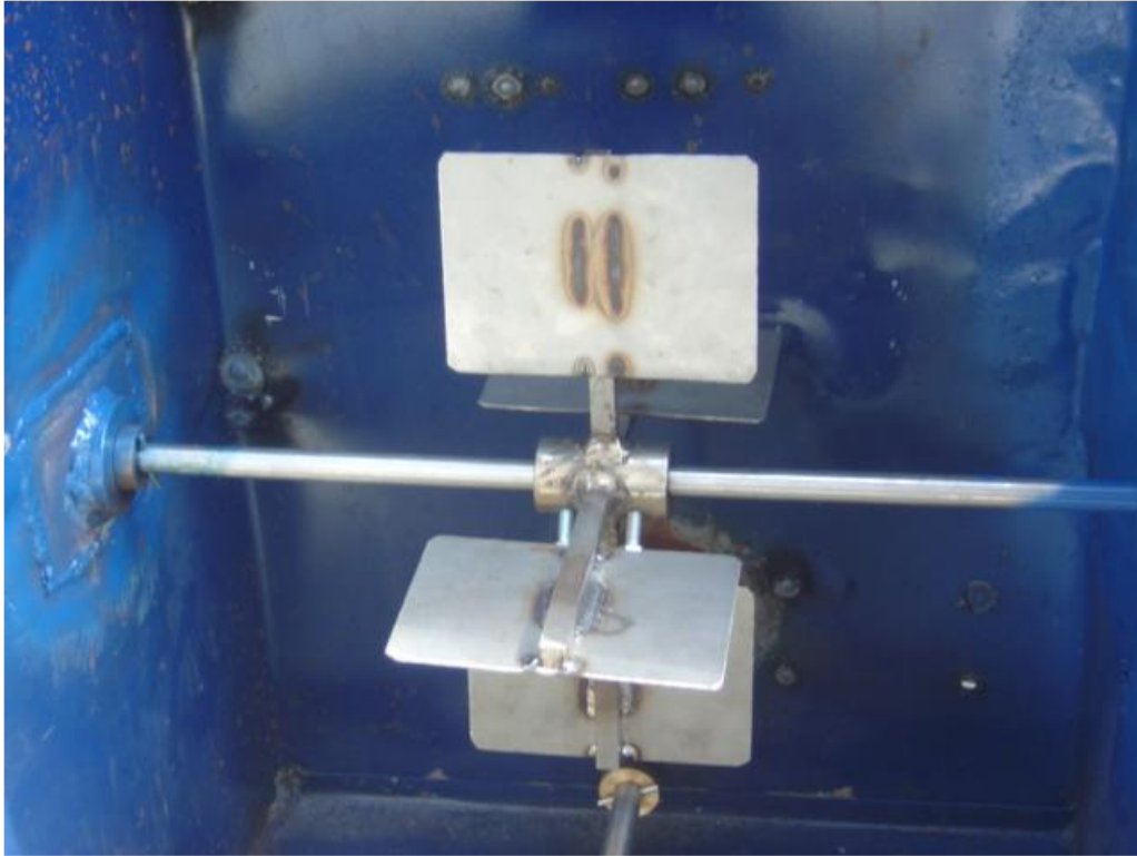
Foto E2: Eje cruzado con hélice de cuatro paletas
