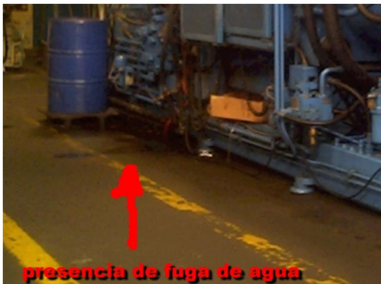
Figura 9.3.2 Punto de frecuente limpieza – puntos de fugas de agua
