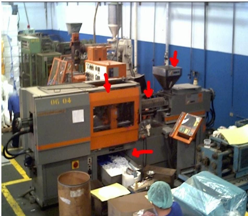
Figura 9.1.1 Puntos de riesgo en la inyectora
