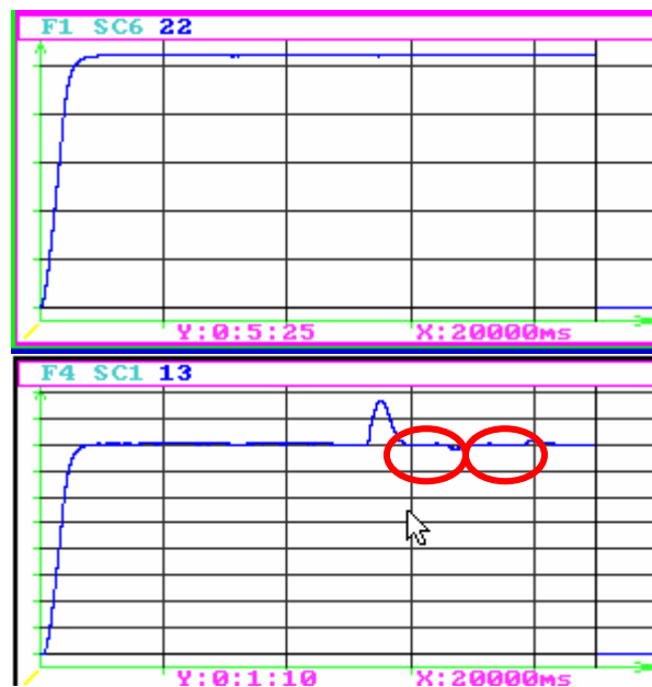
FIGURA 4.1.5 CURVA DE VOLTAJE Y FRECUENCIA A 8 VDC FRENTE A PERTURBACIONES
