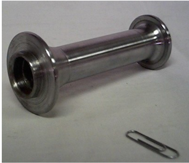
Fig. 3.5. Apoyo de eje
