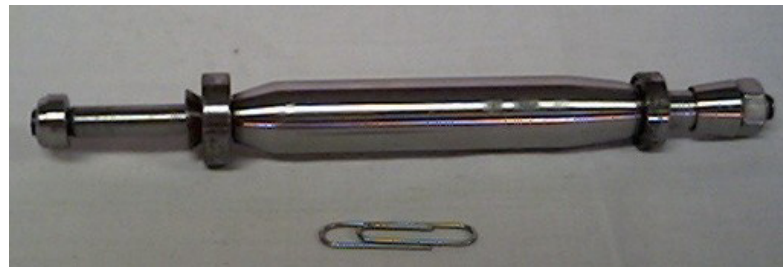
Fig. 3.3. Eje de compresor-turbina con separadores y rodamientos.
