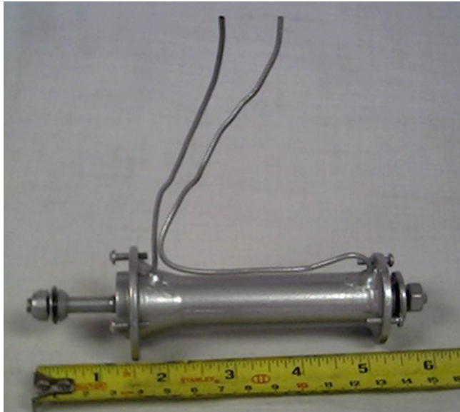
Fig. 3.6. Apoyo de eje con sistema de lubricación
