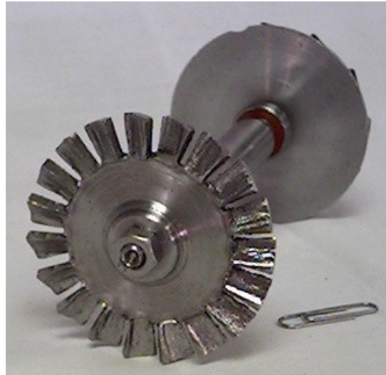
Fig. 3.10. Rotor de turbina acoplado al eje.
