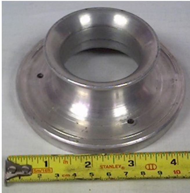
Fig. 3.2. Toma frontal de aire del compresor
