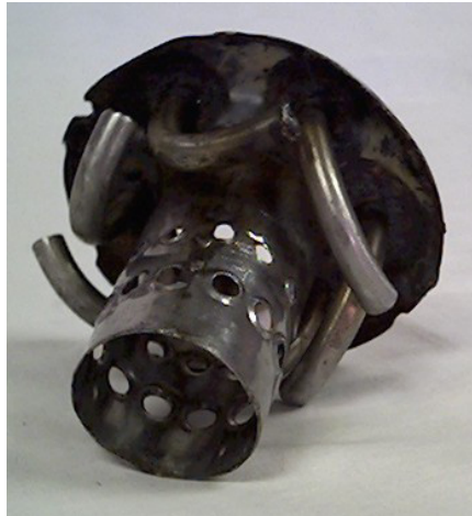
Figura 3.8. Parte frontal de la cámara de combustión con tubos vaporizadores
