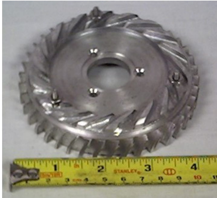
Fig. 3.1. Estator de compresor
