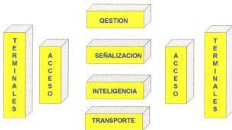
Figura 1.1 Diagrama esquemático de la arquitectura de una red telefónica
