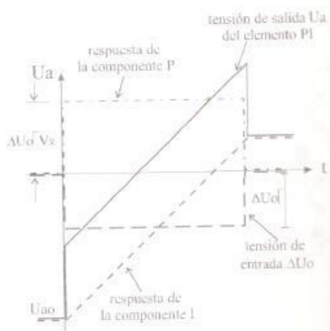
figura 2.5.-Respuesta a un escalón ( U_a ) correspondiente a un elemento de acción proporcional e integral. En la figura se observa que esta respuesta está formada por la respuesta proporcional y por la respuesta integral que aparecen para una entrada en escalón \Delta U_0 de altura \Delta U_0 .
