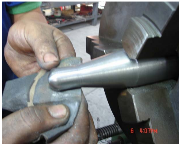
FIGURA 3.3 CONSTRUCCIÓN DEL DARDO DE IMPACTO
