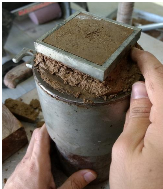
Figura 4.12 Material en la caja de corte. Fuente: Rodríguez, M., Salazar, R., 2017
