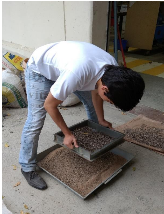
Figura 4.8 Proceso de cuartear el material. Fuente: Rodríguez, M., Salazar, R., 2017
