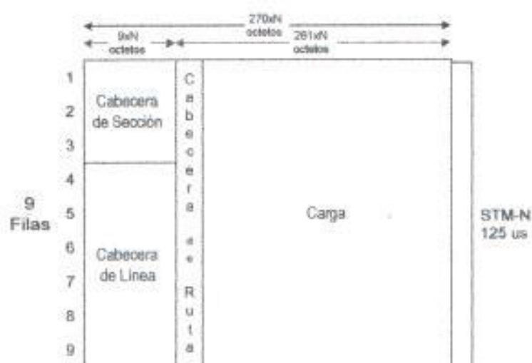
Figura 2.3 Estructura de trama STM-N
