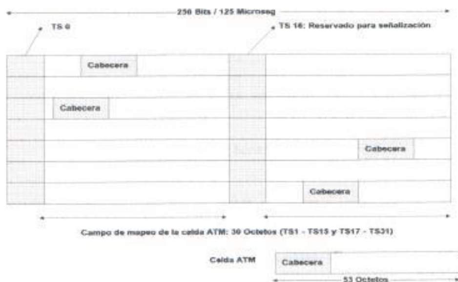
Figura 2.15 Trama E1 usada para transportar celdas ATM
