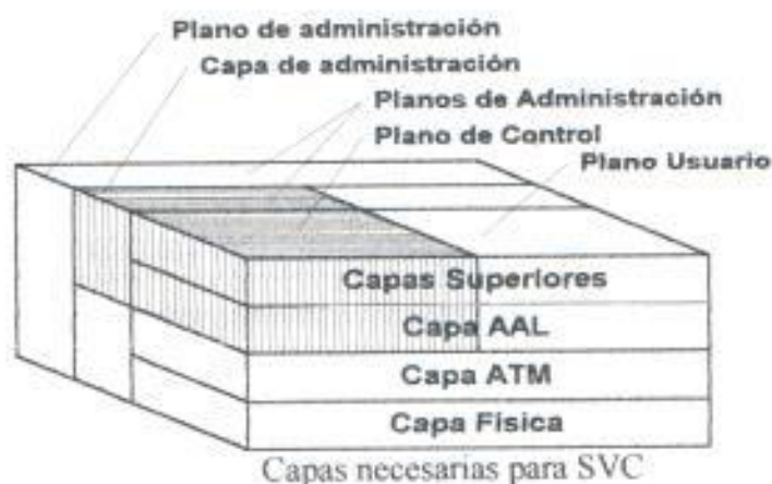
Figura 1.5 Modelo de referencia ATM y B-ISDN
