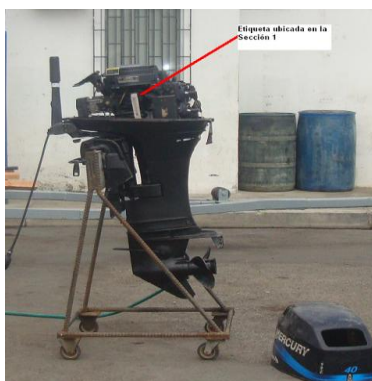
(b) Motor fuera de borda con la etiqueta ubicada en la Sección 1
