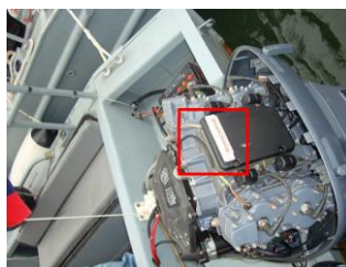
Figura 4.15: Ubicación de la etiqueta en el motor fuera de borda de 115 HP
