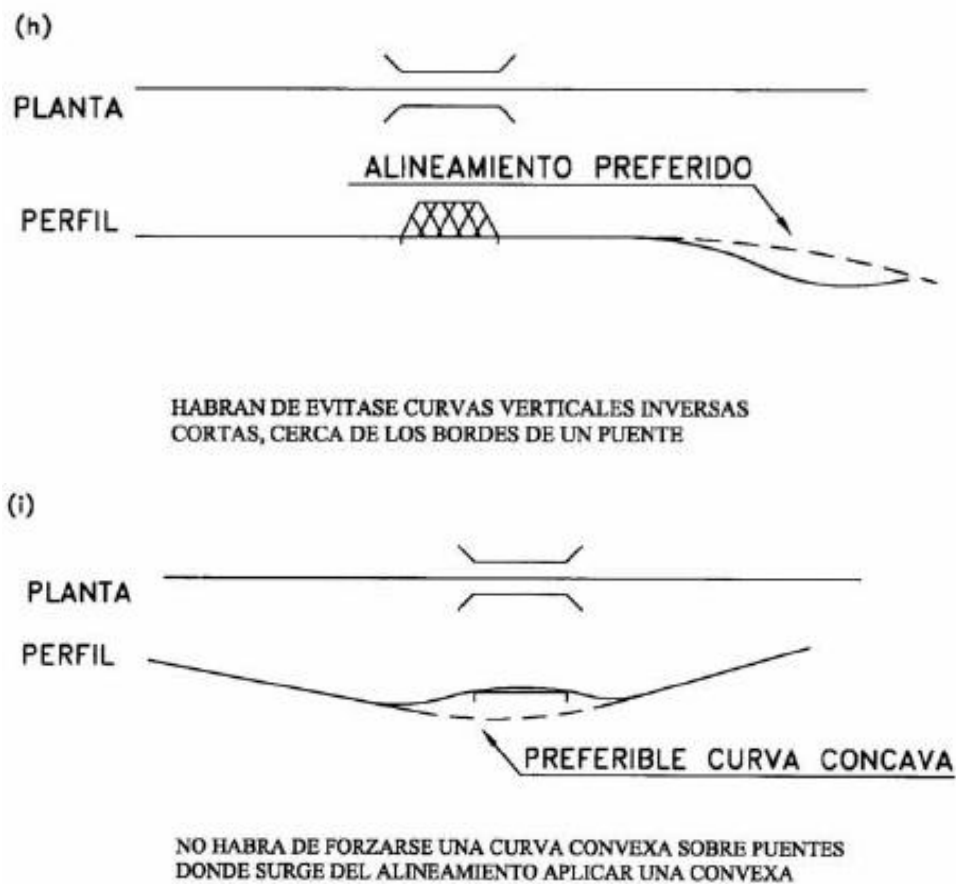
Figura 3.10 Soluciones de problemáticas entre alineamientos.
