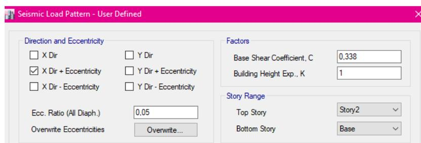
**Figura 4.8** Propiedades de la carga sísmica en dirección X.
