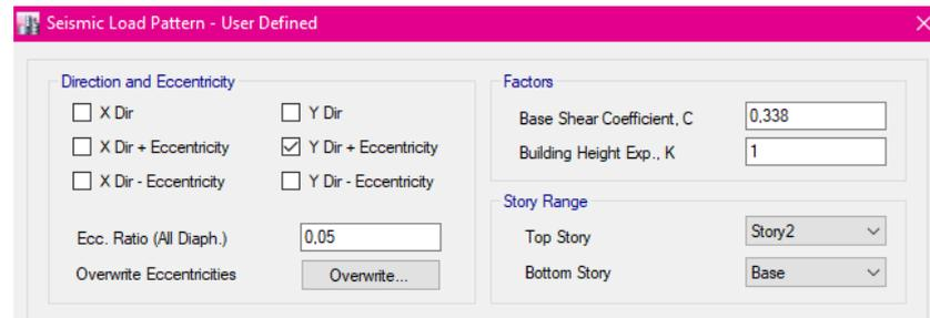
**Figura 4.9** Propiedades de la carga sísmica en dirección Y.
