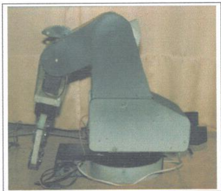
FIGURA 18 VISTA LATERAL DE LA POSICIÓN DE MÍNIMO ALCANCE
