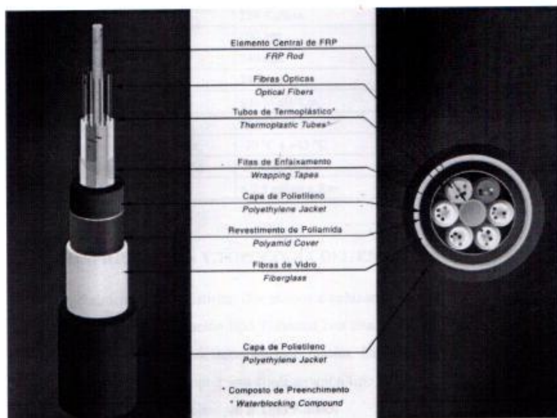
Fig. 4.6: Cable para Instalación Enterrado/Canalizado.
