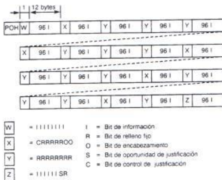
Fig. 3.6: Estructura VC-4 de 9 hileras
