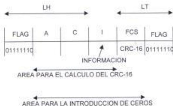
FIG. 2.10.- Area cubierta por el FCS
