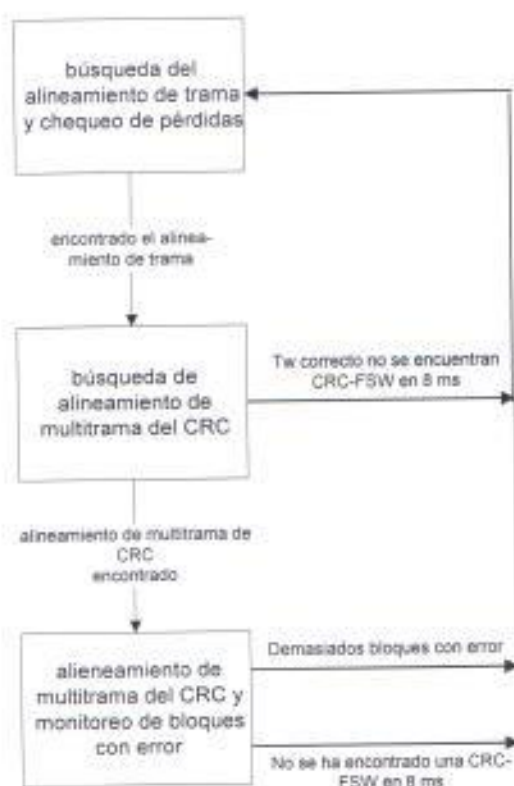
FIG. 4.3.- Chequeo de CRC en multitrama
