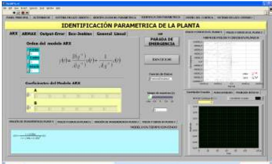
2.- Seleccionar un modelo, con el número de polos y ceros, que se estimaron en la Identificación No Paramétrica, ajustar el tiempo de muestreo a 60 milisegundos y seleccionar como fuente de datos "Load From File".
