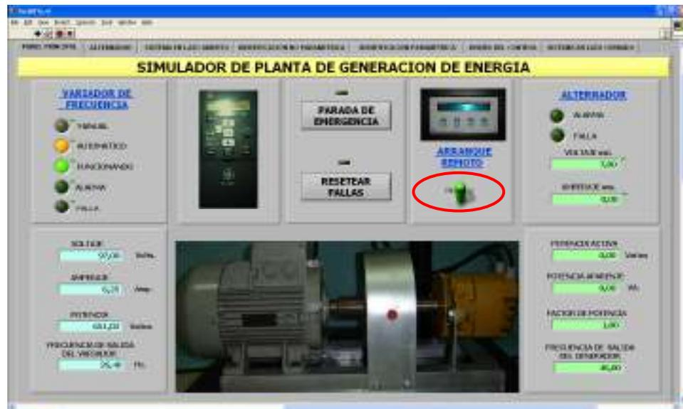
6. Al seleccionar la pestaña ALTERNADOR, se puede monitorear los parámetros del generador.
