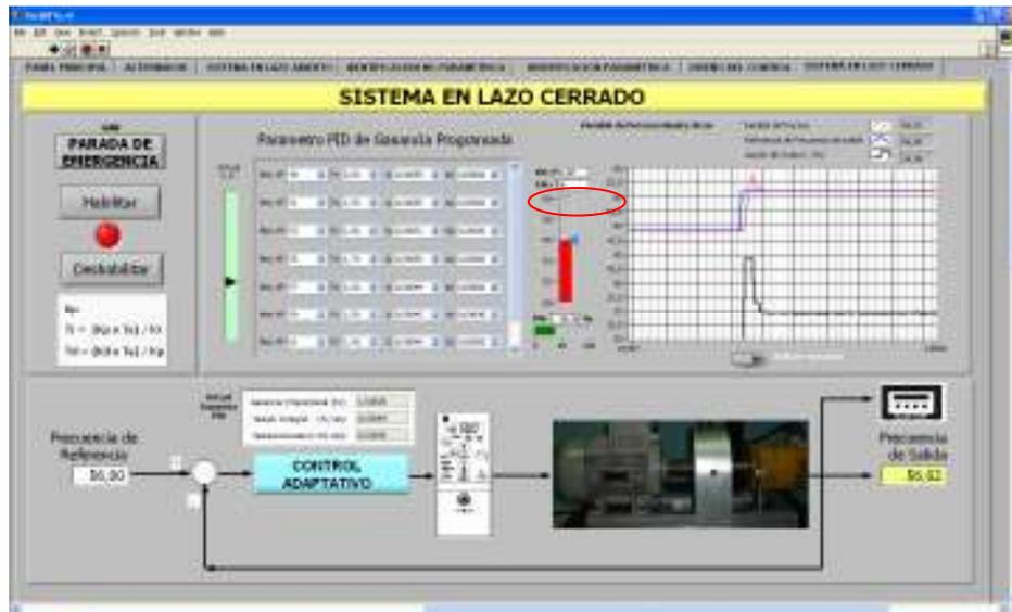
8.- Oscilar la referencia usando el botón Aplicar variación, el cual aplicara un paso escalón de 1 Hz. A la referencia.
