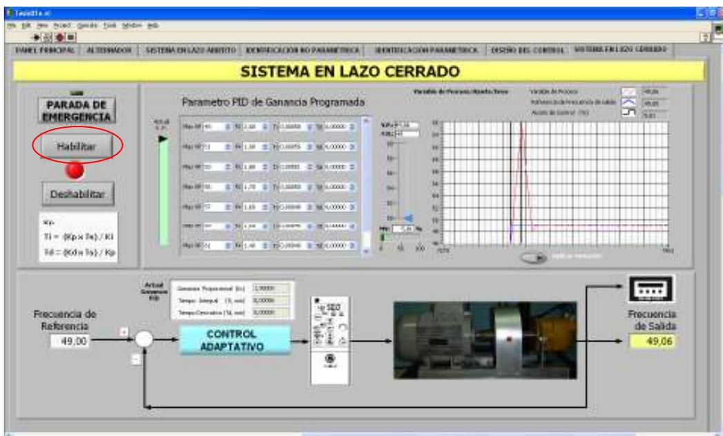
7.- Ajustar la referencia a un valor entre 50 y 60 Hz en la ventana F.R., usted podrá apreciar como la frecuencia de salida sigue a la referencia. En forma análoga, seleccionar el comportamiento del sistema al variar dicha referencia.
