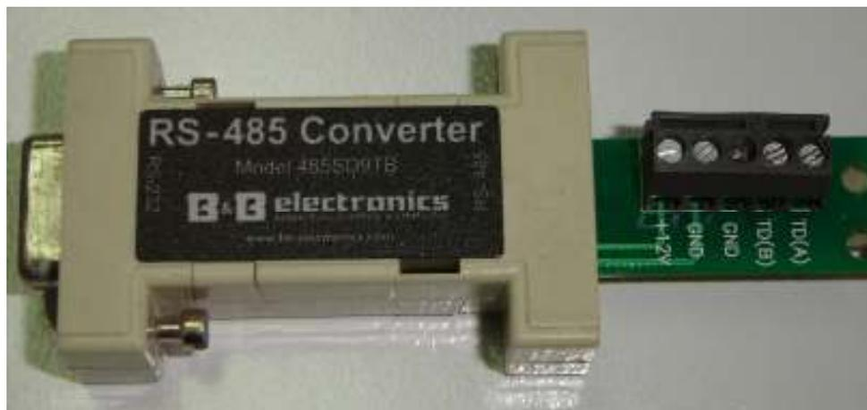
**Figura 23. Convertidor de Protocolo de RS485 a RS232.**
