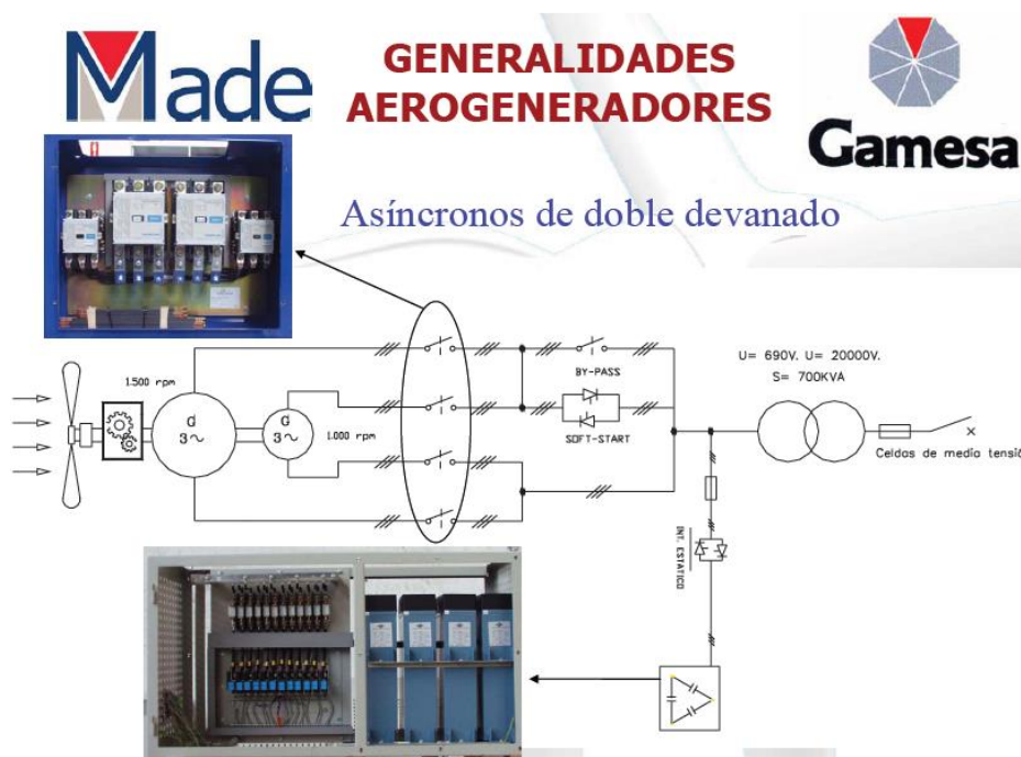
Figura 2.2 Generador Asíncrono de doble devanado
