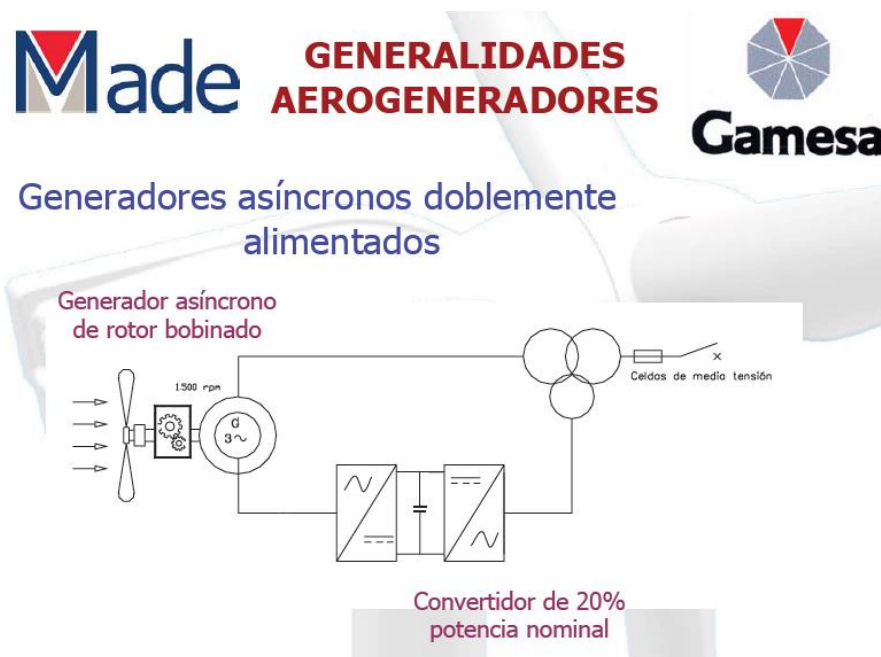
Figura 2.3 Generador asíncrono doblemente alimentado
