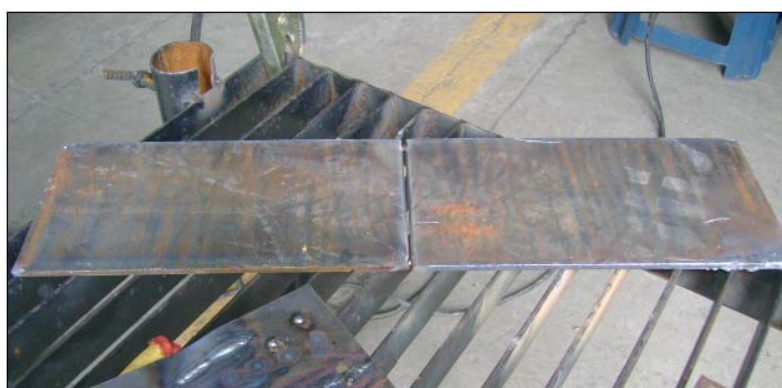
FIGURA 4.20: PLANCHAS LISTAS PREVIO A LA SOLDADURA, TOMANDO 2 MEDICIONES A LA PROBETA.
