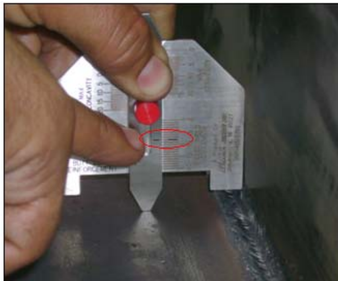
FIGURA 4.47: MEDICIÓN DE LA ALTURA DE LA PIERNA
