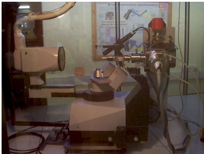
FIGURA 2.18: EQUIPO DE R-X PARA MEDICIÓN DE ESFUERZOS RESIDUALES.
