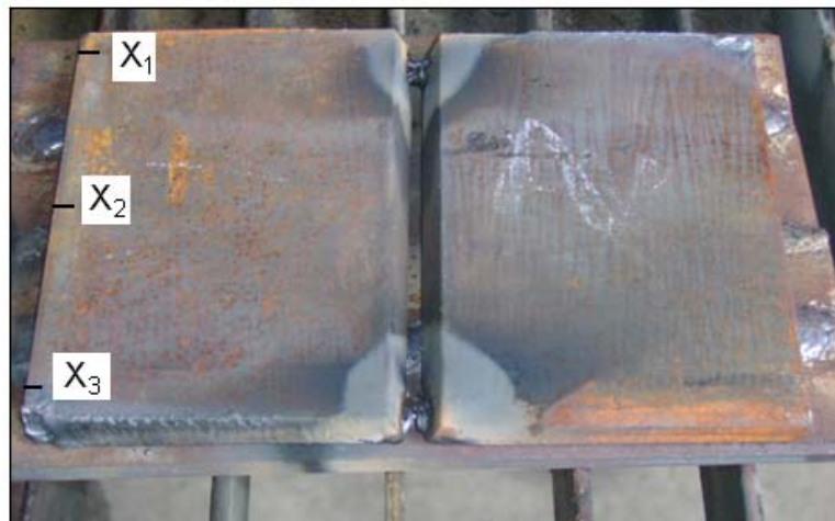
FIGURA 4.3: PUNTOS DONDE SE TOMARON LAS MEDIDAS ANTES DE SOLDAR LAS PLANCHAS.
