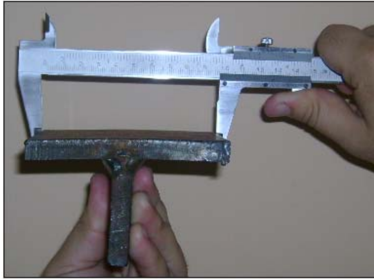
FIGURA 4.16: TERCERA MEDICIÓN, X_3' = 99.35\text{mm}
