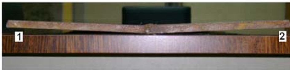
FIGURA 4.51: EFECTO DE LA DISTORSIÓN ANGULAR
