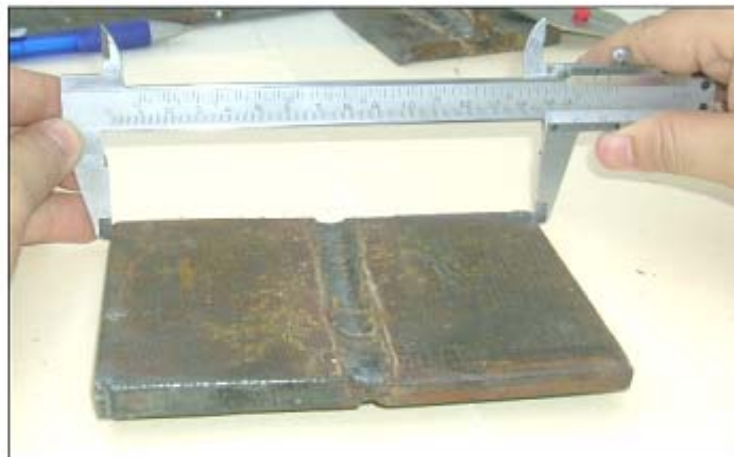
FIGURA 4.6: PRIMERA MEDICIÓN, X_1' = 149.60 mm
