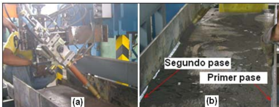
FIGURA 4.38: SOLDADURA DEL SEGUNDO CORDÓN.
