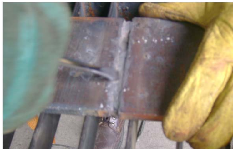
FIGURA 4.4: LIMPIEZA DE LA ESCORIA LUEGO DEL PRIMER CORDÓN DE SOLDADURA.
