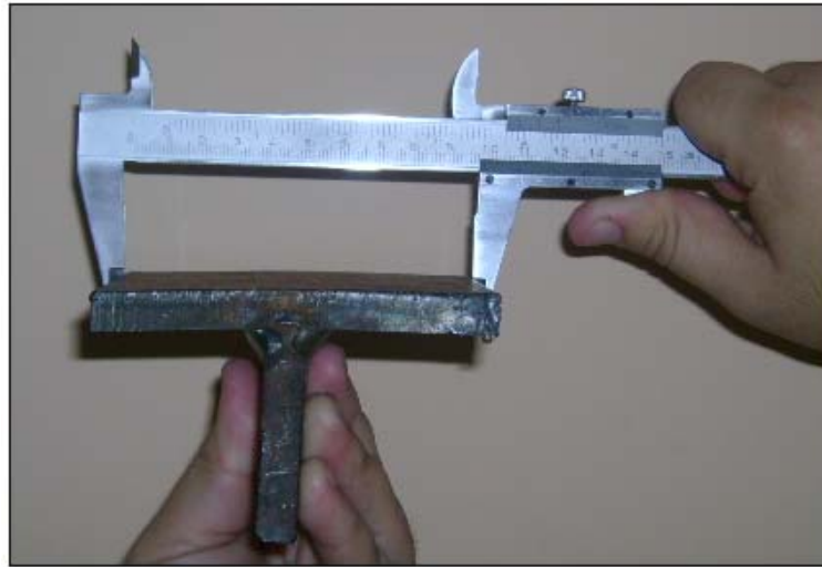
FIGURA 4.14: PRIMERA MEDICIÓN, X_1' = 99.10 mm
