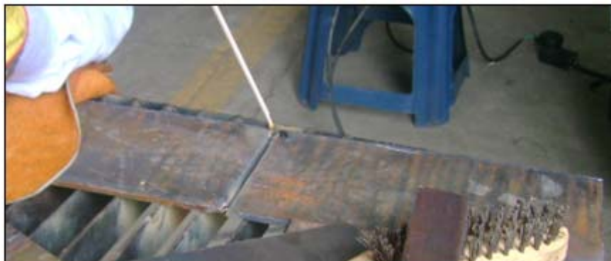
FIGURA 4.23: SOLDADURA DE LAS PLANCHAS EN POSICIÓN 1G CON PROCESO SMAW.
