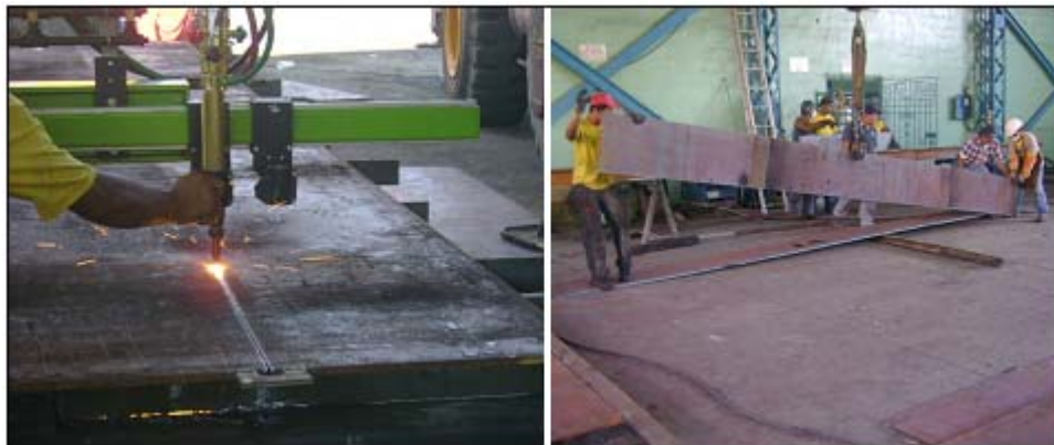
FIGURA 4.28: CORTE Y PREPARACION DE LAS PLANCHAS ANTES DE SOLDARLAS.
