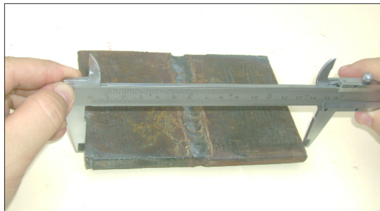
FIGURA 4.8: TERCERA MEDICIÓN, X_3' = 149.70 mm
