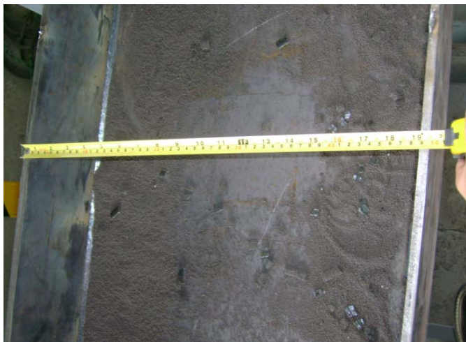
FIGURA 4.37: DISMINUCIÓN DE LA DISTANCIA ENTRE LAS ALAS DEBIDO A LA DISTORSIÓN ANGULAR
