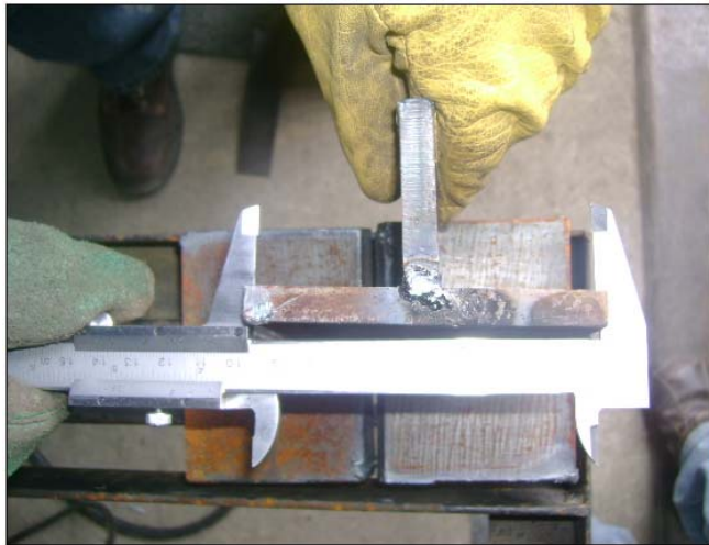
FIGURA 4.11: PUNTOS DONDE SE TOMARON LAS MEDIDAS ANTES DE LA SOLDADURA.
