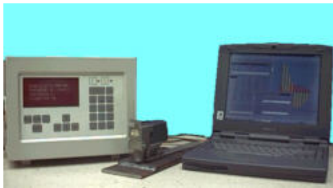
FIGURA 2.19: EQUIPO DE ULTRASONIDO PARA MEDICIÓN DE ESFUERZOS RESIDUALES (SISTEMA UCC) (9).
