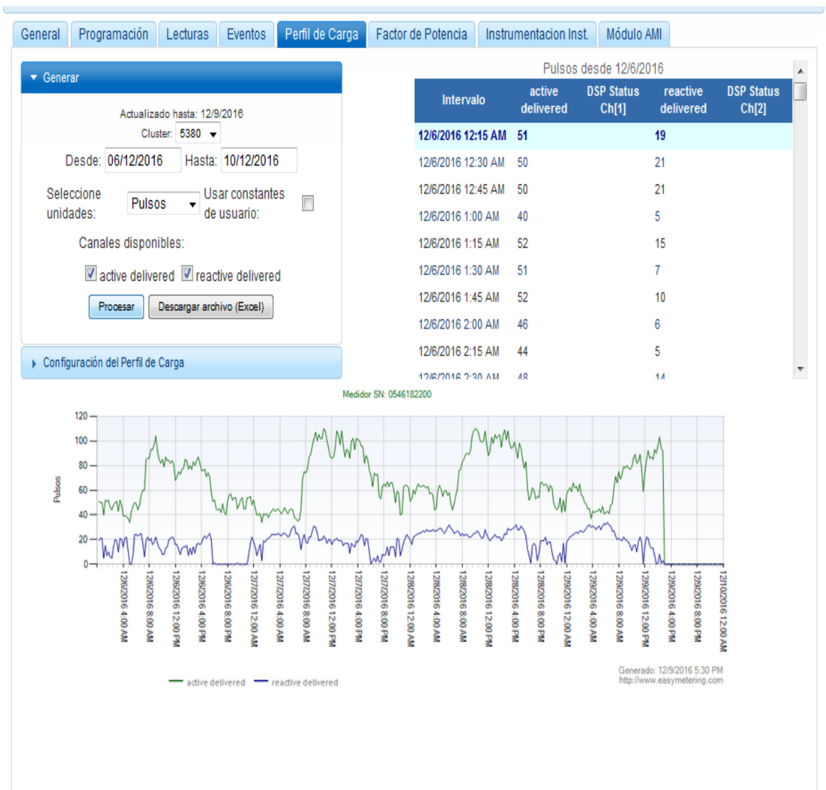
Figura 2.6: Plataforma de Telemetría, mostrando el perfil de carga de las condiciones eléctricas del Clientes Especial.
