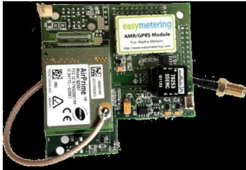
Figura 2.1: Tarjeta de Telemetría para captura de parámetros eléctricos del medidor.
