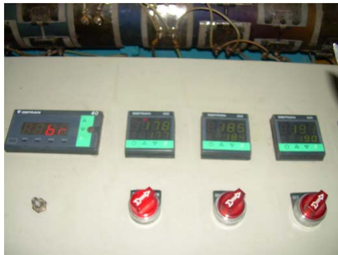
FIGURA 3.2. CONTROL DE TEMPERATURA DE 3 SECCIONES DEL BARRIL DE EXTRUSORA
