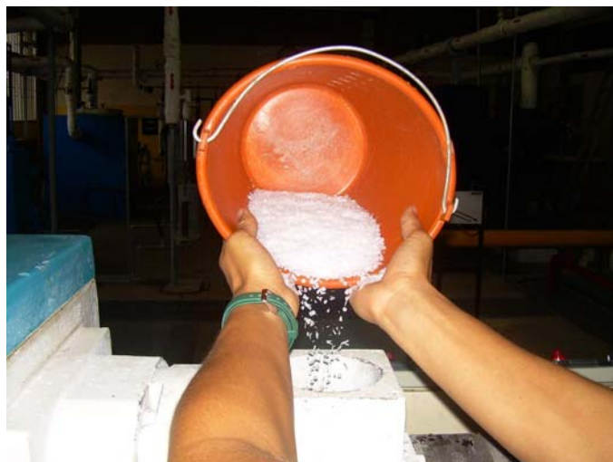
FIGURA 3.3. APLICACIÓN DEL MEZCLADO EN EL ALIMENTADOR DE LA EXTRUSORA
