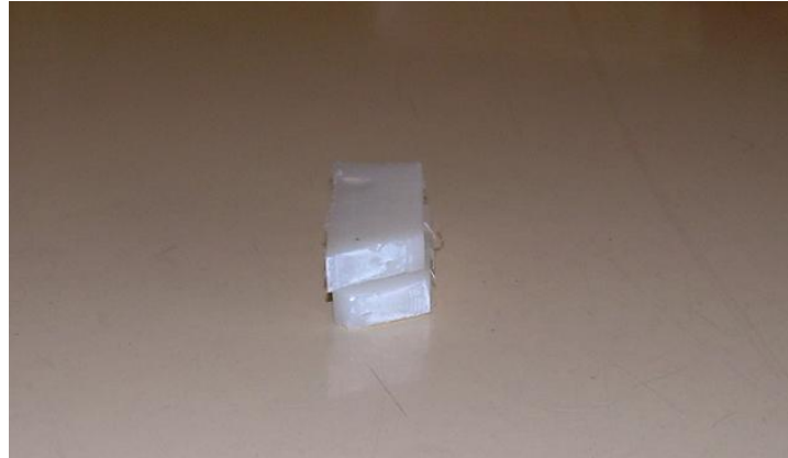
FIGURA A1. PROBETA DE IMPACTO IZOD CON MEZCLA DE POST-INDUSTRIAL
