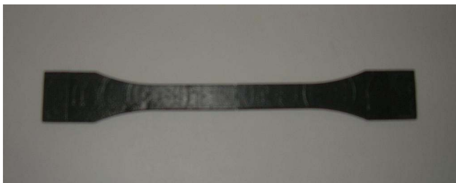
FIGURA 4.2. PROBETA TROQUELADA DE ACUERDO A LA NORMA ASTM D638
