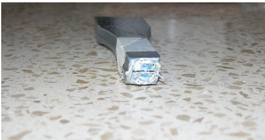
FIGURA 4.4. PROBETA ENSAYADA CON PLÁSTICO DESCONOCIDO EN SU INTERIOR
