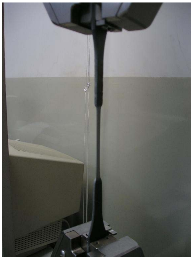
FIGURA 4.3. UNA PROBETA ENSAYADA EN EL TENSÓMETRO QTEST I
