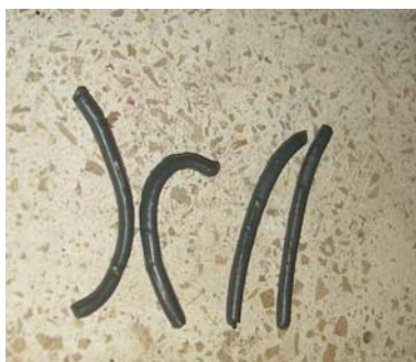
FIGURA 4.8. MUESTRAS DE 0.35 G RESULTANTES DE LA OPERACIÓN EN EL PLASTÓMETRO DE EXTRUSIÓN
