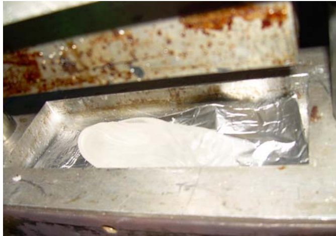
FIGURA 3.5. INSERCIÓN DEL MATERIAL EXTRUIDO EN LA PRENSA
