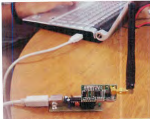
Figura 3.41. Hardware del puerto serial virtual y el módulo HTMR915.
