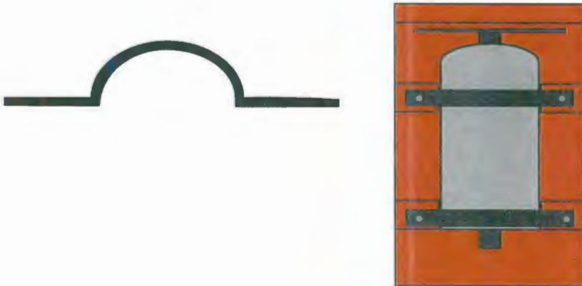
Figura 4.6 Forma y ubicación de las abrazaderas.
