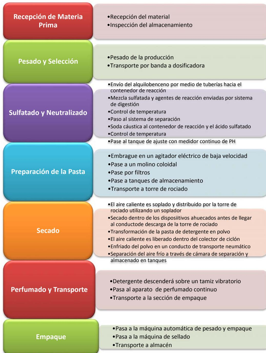
FIGURA 3.2 DIAGRAMA DEL FLUJO DE PROCESO DEL DETERGENTE
