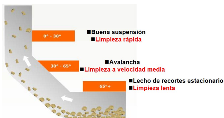
Figura 2.2: Efecto del ángulo de inclinación en la limpieza de hoyo
