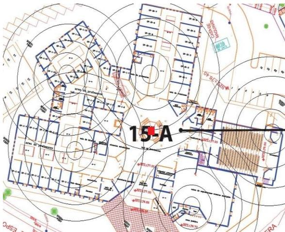
Figura 7 Gráfico de emisión de señales de los puntos de acceso del Bloque 15 A
