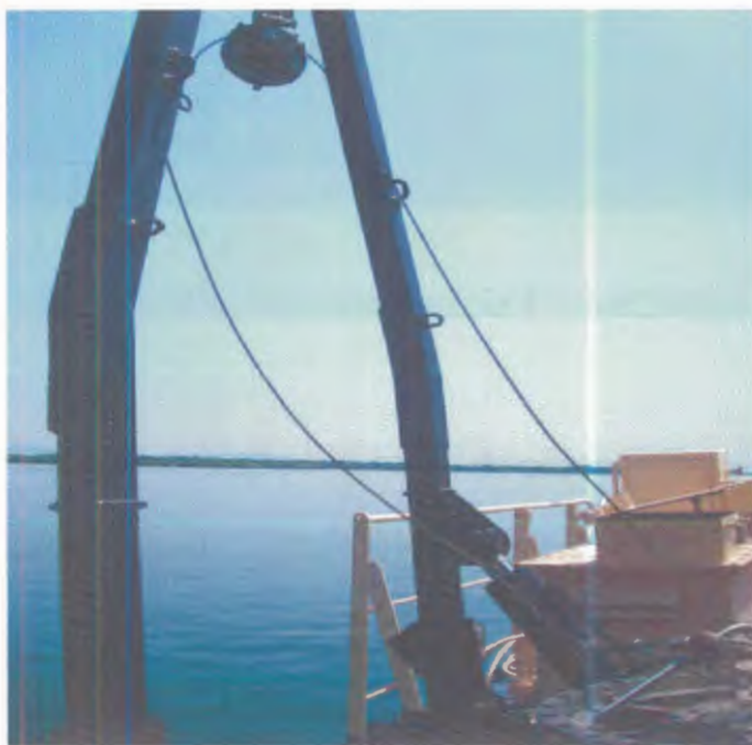
FOTO 27.- Marco en A lateral, se utiliza para maniobra con la roseta.
