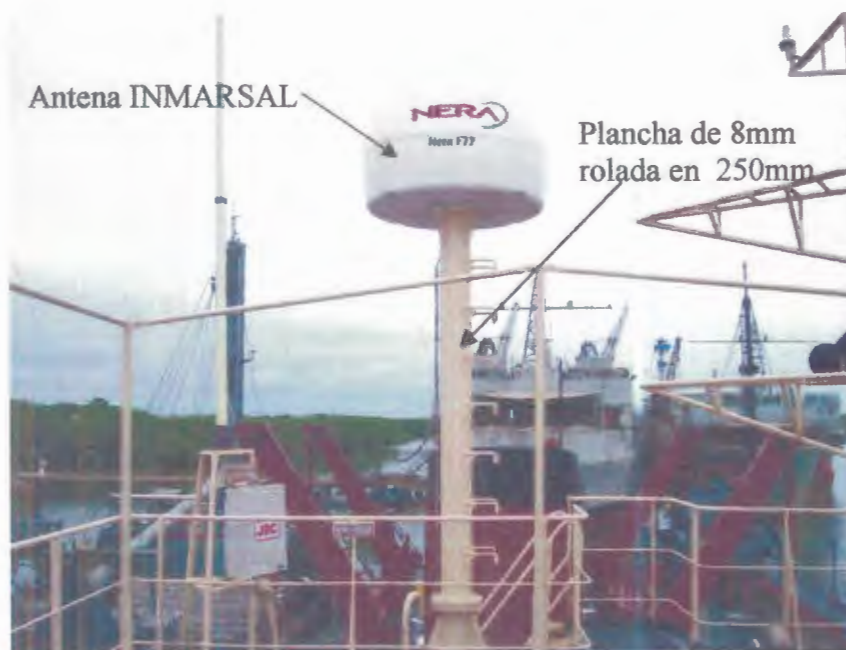
FOTO 18.- Antena INMARSAL ubicada en la cubierta del magistral (tubo rolado de 25 mm de diámetro en plancha de 8 mm).
