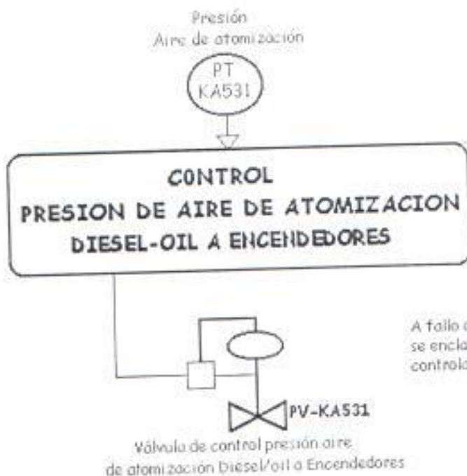
A fallo de aire abre y a fallo de señal se enciava. Al aumentar la señal del controlador, la válvula se va cerrando.
