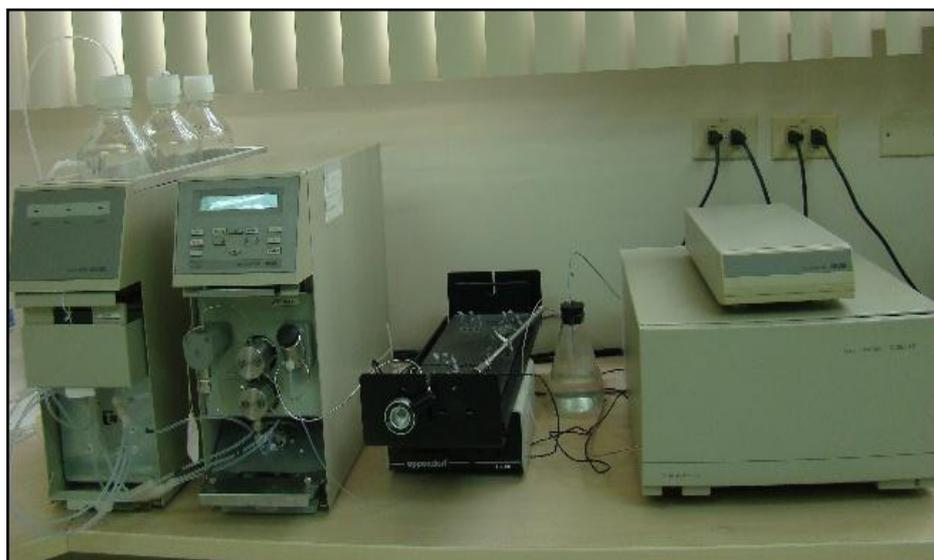
**Figura 3.1** Sistema para Cromatografía Líquida de Alta Eficacia HPLC
