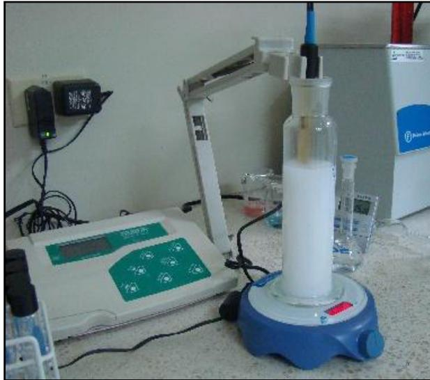
**Figura 3.9** Ajuste del pH de la solución
