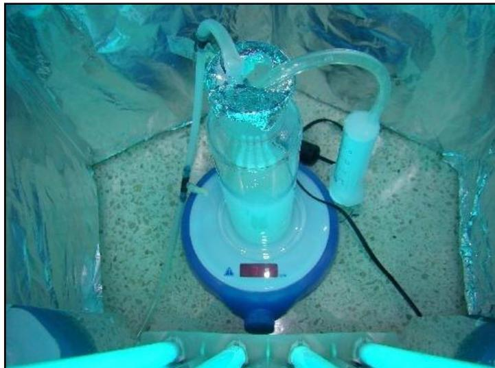
**Figura 3.10** Sistema para efectuar las reacciones de degradación
