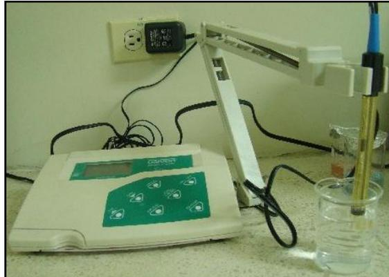
**Figura 3.6** Medidor de pH
