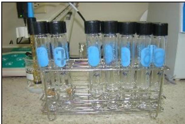
**Figura 3.11** Muestras filtradas de la reacción fotocatalítica
