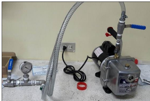
Figura 3.7 Pruebas de estanqueidad en conexiones
