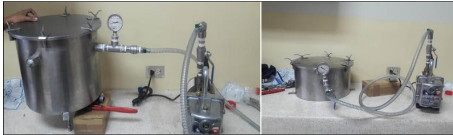
Figura 3.6 Pruebas de estanqueidad en el recipiente de la trampa de frio y recipiente de muestras
