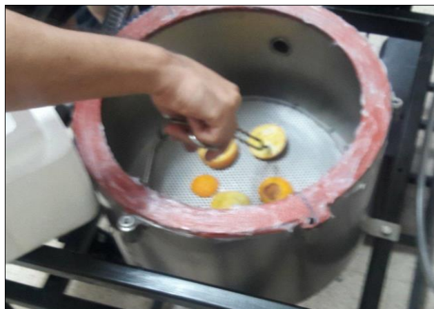
Figura 3.12 Colocación de muestras en la Cámara de secado
