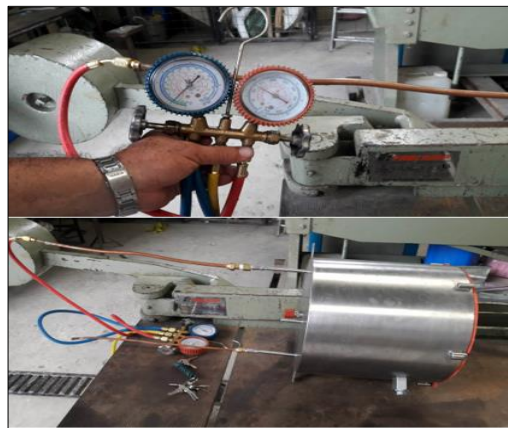
Figura 3.8 Lectura de manómetro de 125 psig no disminuyó durante las pruebas
