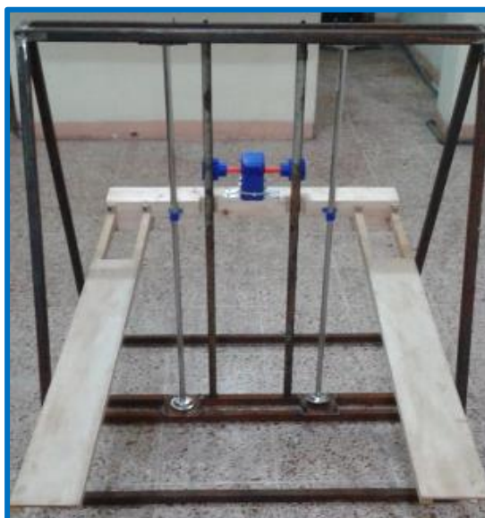
Figura 3.9 Prueba de autobloqueo
