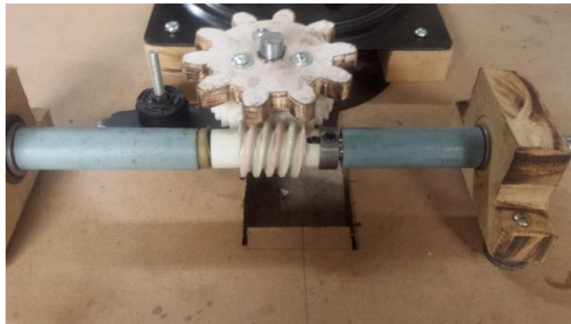
Eje principal apoyado en soportes fijados a la base.
