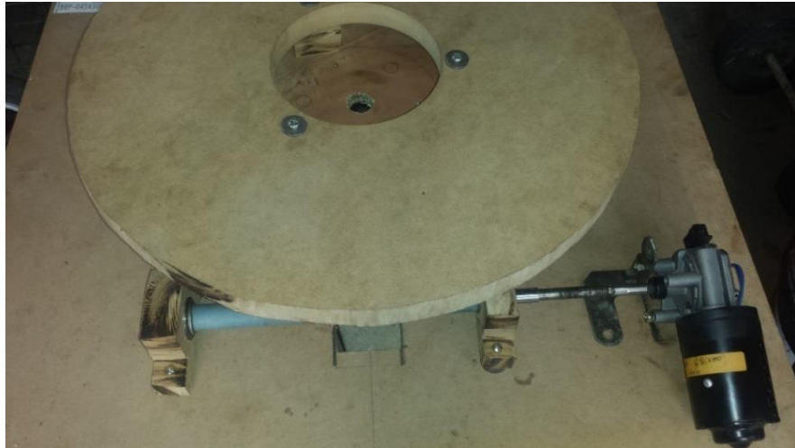
Base circular fijada sobre alzas acopladas al engrane dientes rectos
