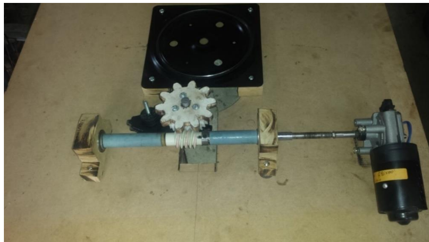
Conexión del eje principal con el motor
