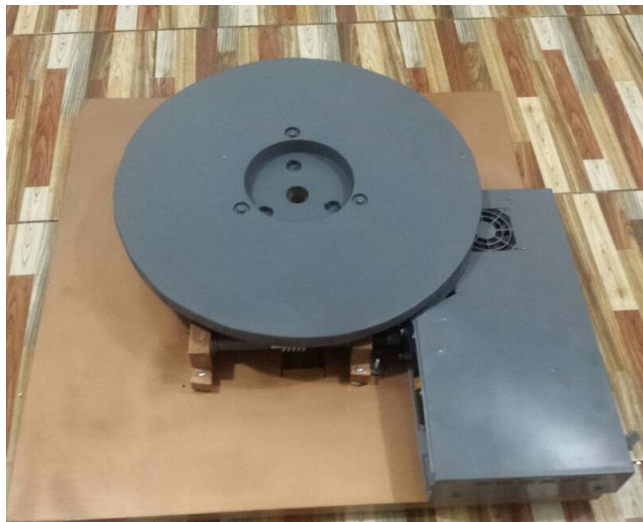
Base circular fijada sobre alzas acopladas al engrane dientes rectos
