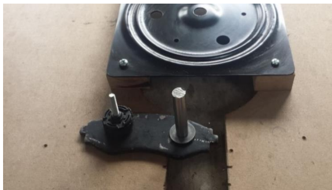
Rodamiento y Eje secundario fijados a base cuadrada
