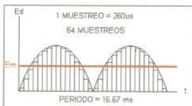
Figura 3.4: Determinación de la corriente promedio.
