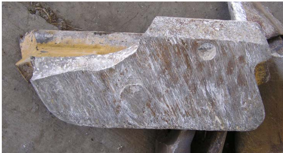
FIGURA 1.13 ROTURAS EN LOS EXTREMOS DE LAS HERRAMIENTAS DE CORTE DE LAS CARGADORAS DE RUEDAS
