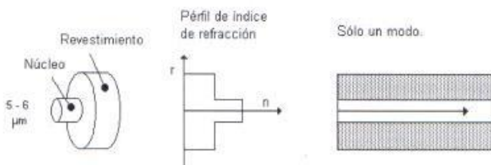
figura 2.19.-índice escalonado fibra monomodo
