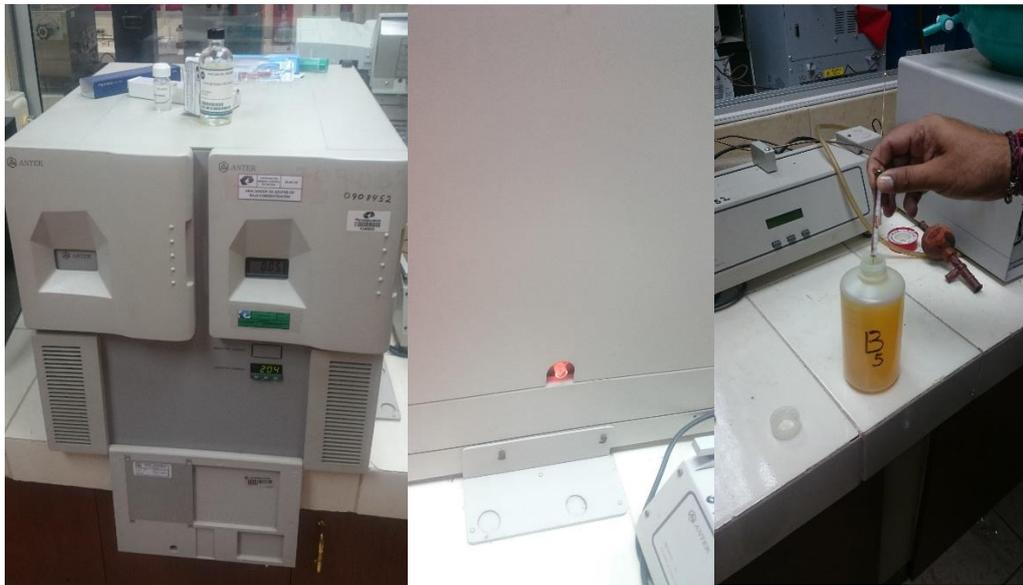
**Figura XIII. Prueba contenido de azufre en las instalaciones de la Refinería de La Libertad**
