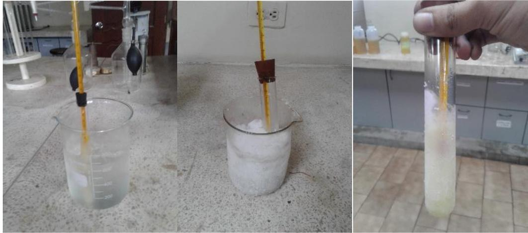
**Figura XII. Punto de fluidez o escurrimiento (Sistema agua con hielo y sistema hielo seco)**
