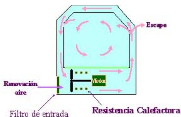
**Figura 4.3** Distribución de calor en una termocuna.
