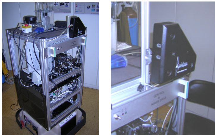
Figura 4.7.- Cámara Digiclops montada sobre el robot TRC.
