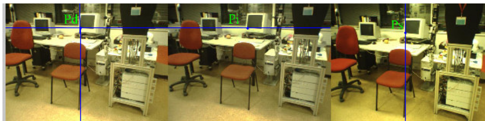
Figura 3.3.- ( Superior ) Geometría epipolar para la cámara; ( inferior ) líneas epipolares para las proyecciones del punto P – P_d , P_i y P_s – en las 3 imágenes adquiridas con la cámara: derecha, izquierda y superior.
