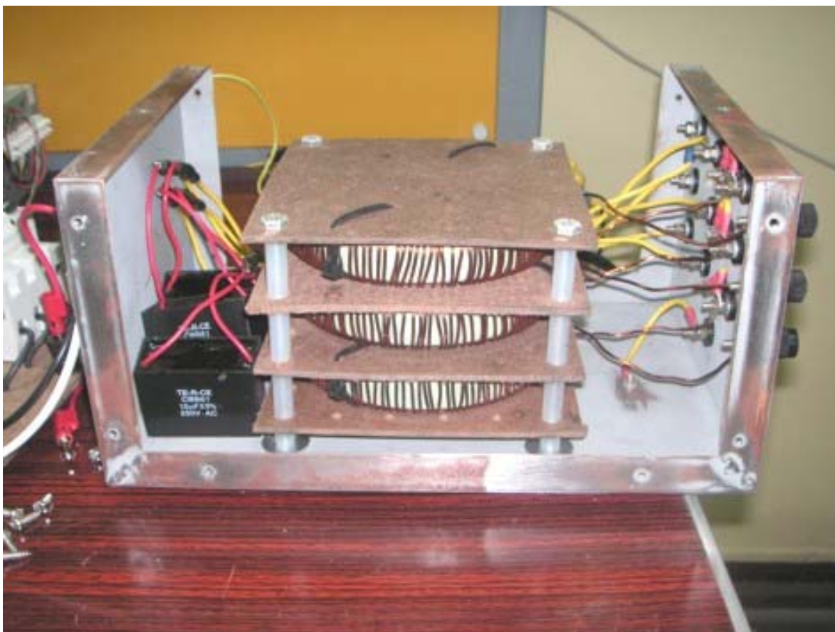
Foto K.9 Inductores y capacitores montadas en el chasis (vista interior)
