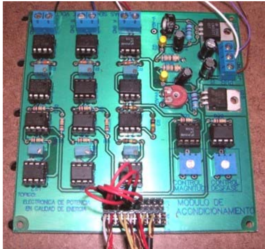
Foto K.1 Módulo "Acondicionamiento y Control"
