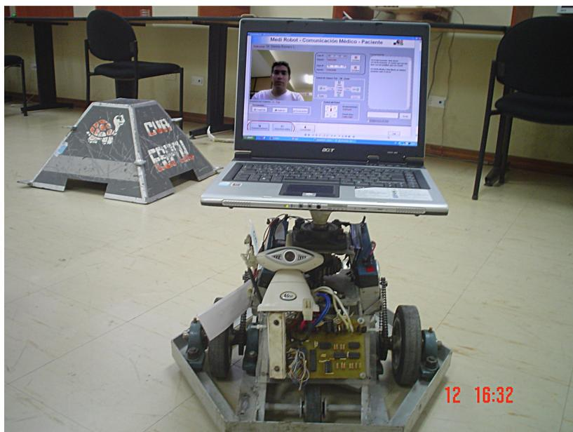
Fig. 5.6: Sistema Medi-Robot montado sobre un robot desarrollado en el CVR
