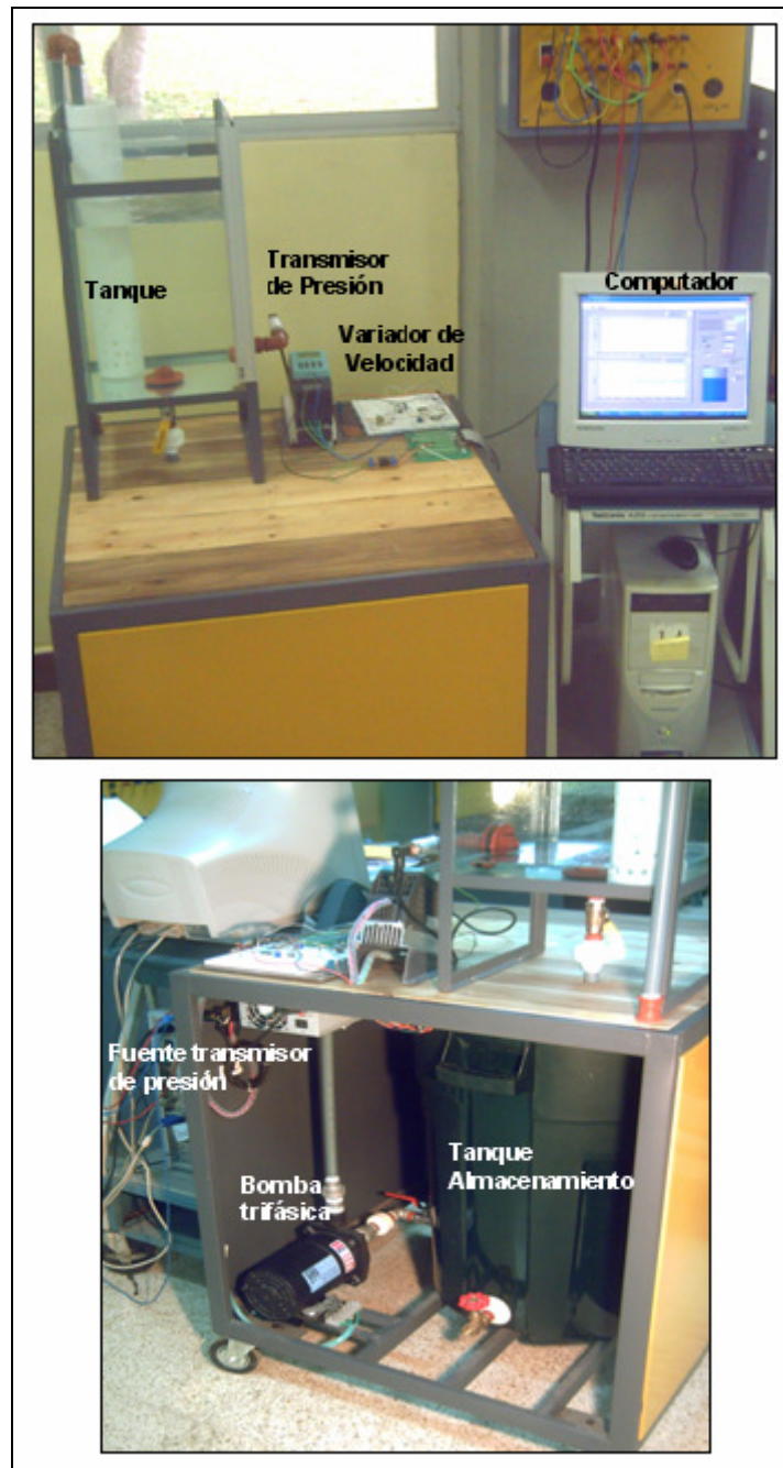
FIGURA 2.3 DISPOSICIÓN FÍSICA DE EQUIPOS EN LA PLANTA.
