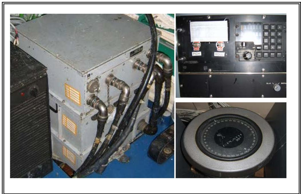
**Figura No 3-3 Plataforma Inercial**
