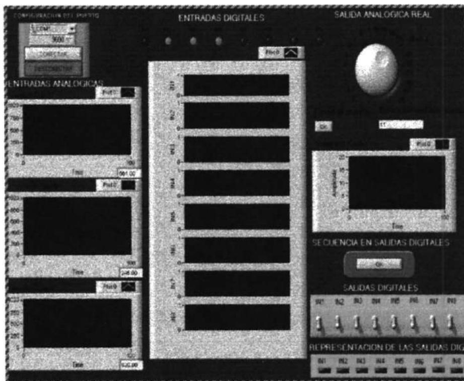
**Figura 3.30.-** Interfase de comunicación realizada en labview.
