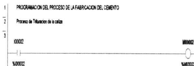
Figura 2.1.- Bobina de paro accionada por I2
