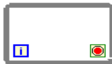
Figura 4-10.- Estructura de lazo mientras “while”.
