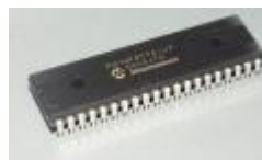
Figura 3- 11.- Foto del PIC 16F877, encapsulado DIP, 40 pines.
