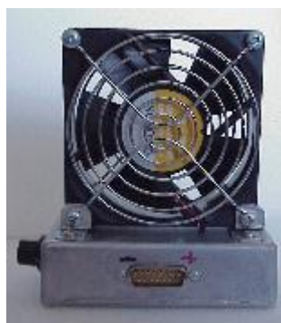
Figura 3- 08.- Motor DC controlado por PIC 16F877.
