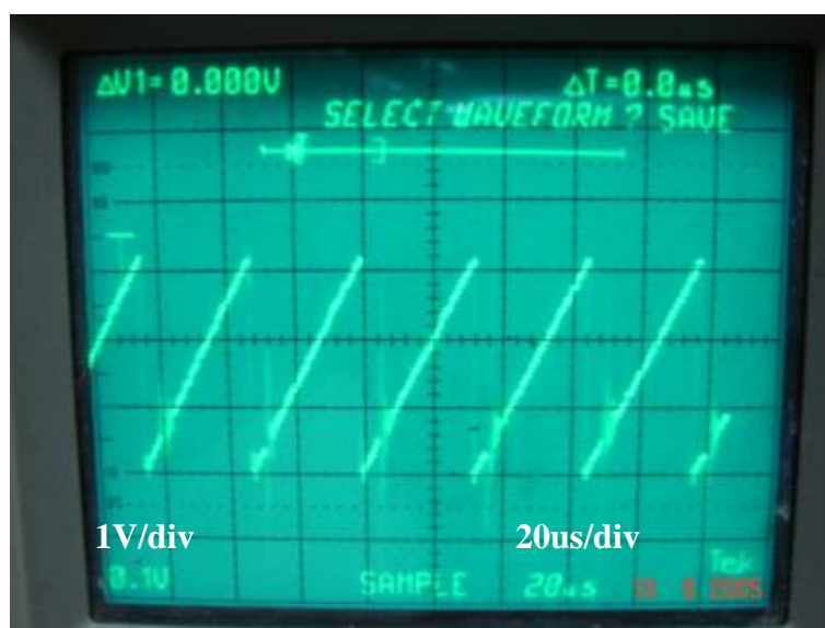
Figura 5-35.- Gráfico de voltaje del pin 5 del C.I TL 494.
