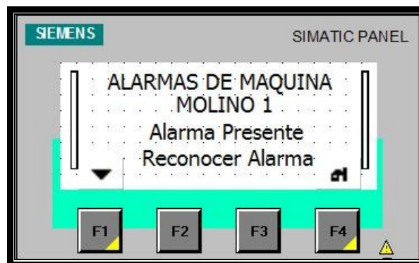
Fig 5.9 Pantalla F3 Principal Status Alarmas.
