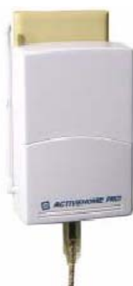
Figura 3.5. Conexión de la Interface CM15A al Tomacorriente.
