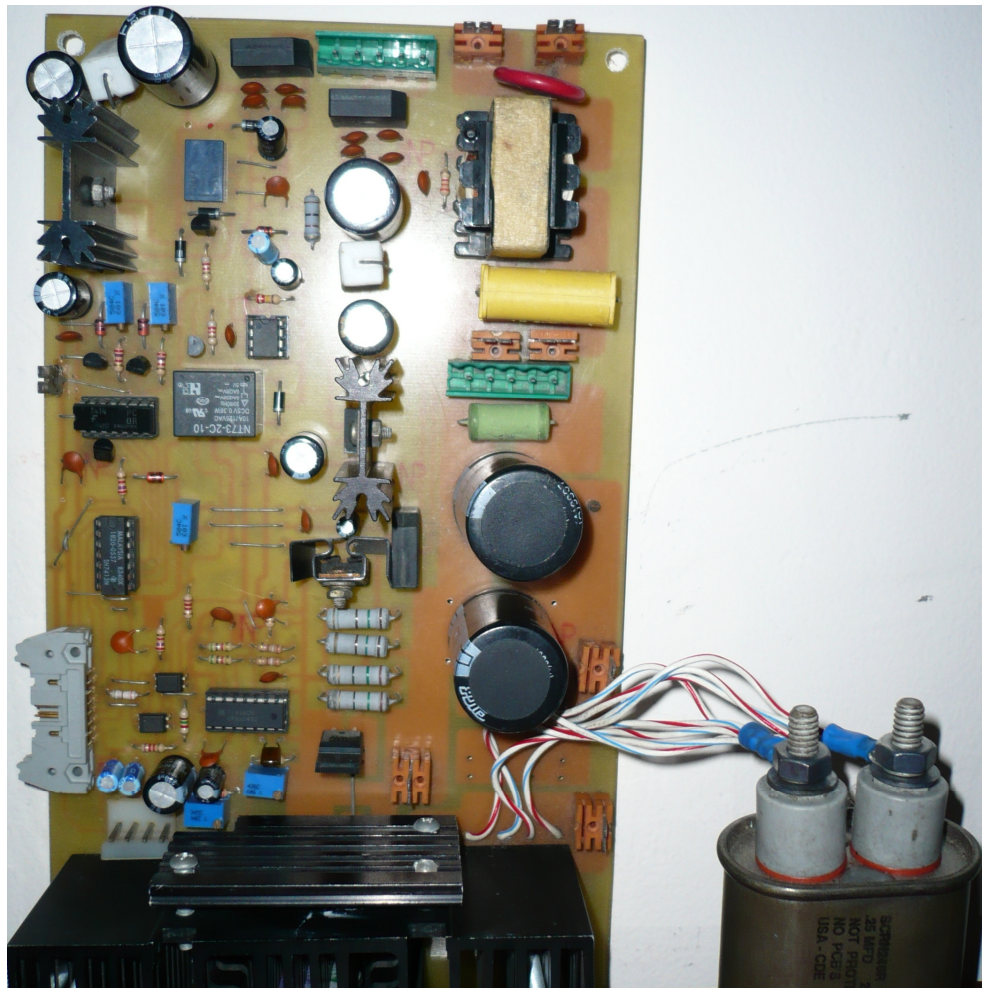
Figura C.6 Foto frontal del Circuito de Potencia.
