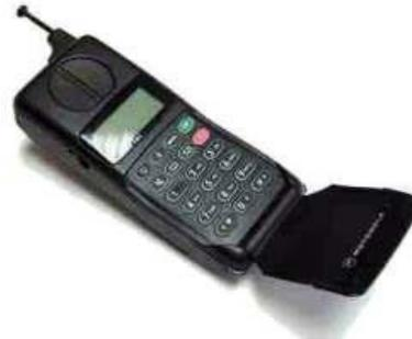
**Figura 1.4.- Motorola MicroTAC, equipo celular 1G**
