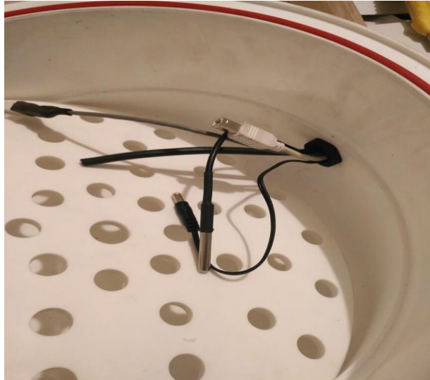
Figura 2. 16: Taladrado realizado a los desecadores para conectar los sensores
