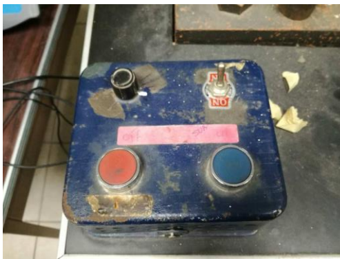
Figura 2.10. Sistema de control de velocidad original instalado en la máquina universal de ensayos.
